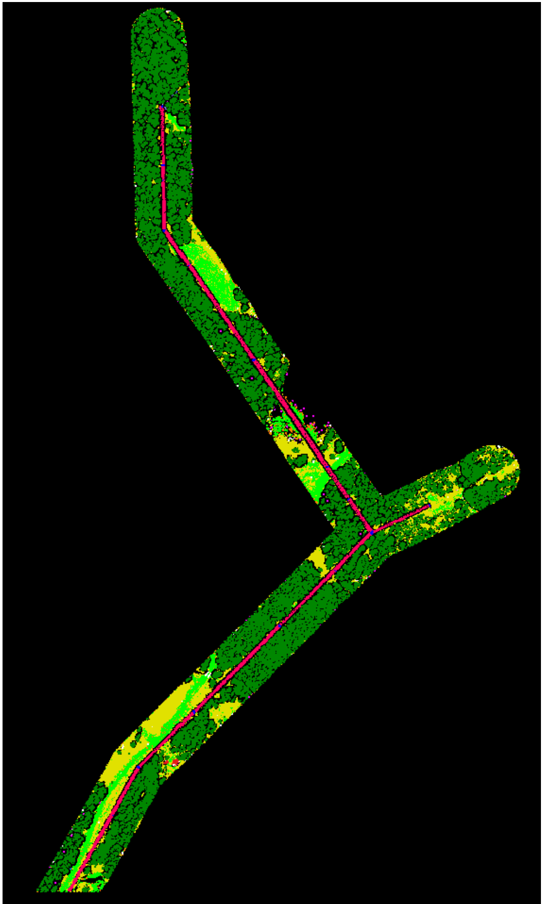
Рис. 3.1.5. Хмара точок після автоматичної класифікації з допомогою макросу.
