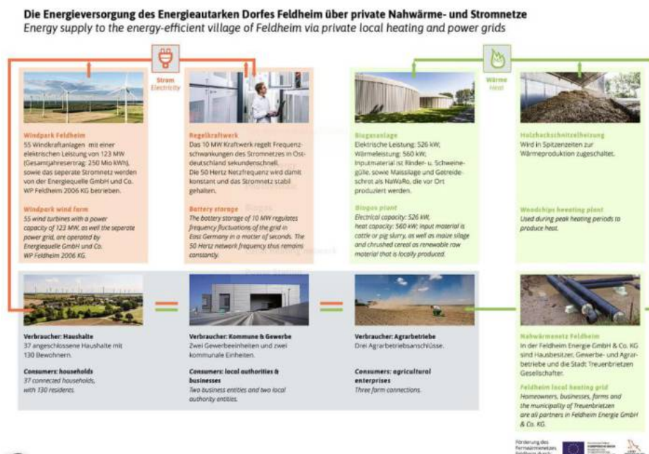
Рис. 1.2.11. Схема постачання енергії до енергоефективного села Фельдгайм через приватні локальні мережі теплопостачання та електропостачання [37]
