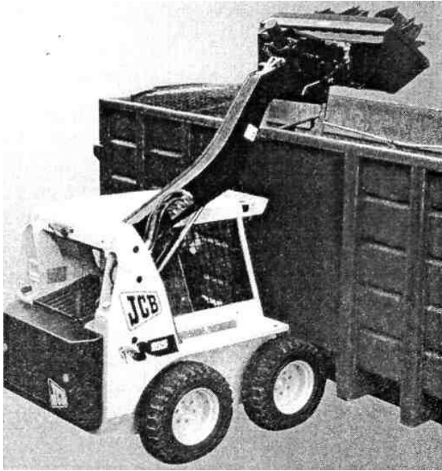
Рис. 3.12. Міні-навантажувач з однобалковою асиметрично розташованою стрілою
