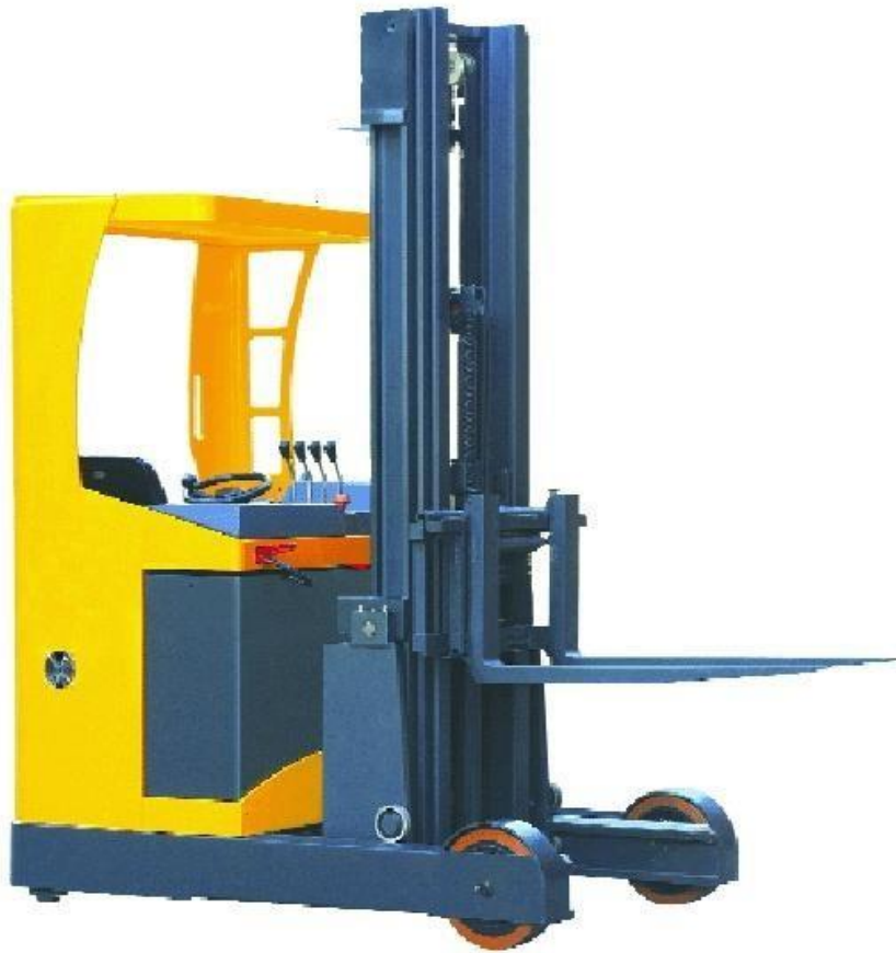
Рис. 2.12. Річтрак с висувною кареткою і вантажозахватом (вилами)
