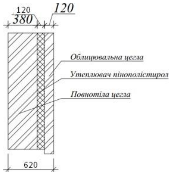
Рис.1. Конструктивне рішення стіни.
