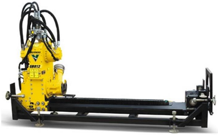
Рис. 3.2 Установка бурова горизонтальна
