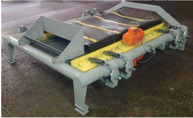
Рисунок 5. Загальний вигляд вібраційного грохота з параметричним збудженнями.
