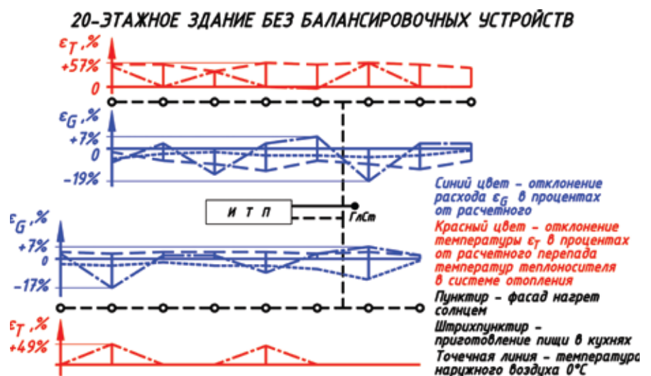
Рис. 2. Отклонение расхода и температуры теплоносителя, сбрасываемого в обратную магистраль системы отопления 20-этажного здания, сбалансированной диаметрами трубопроводов (вариант 1)
