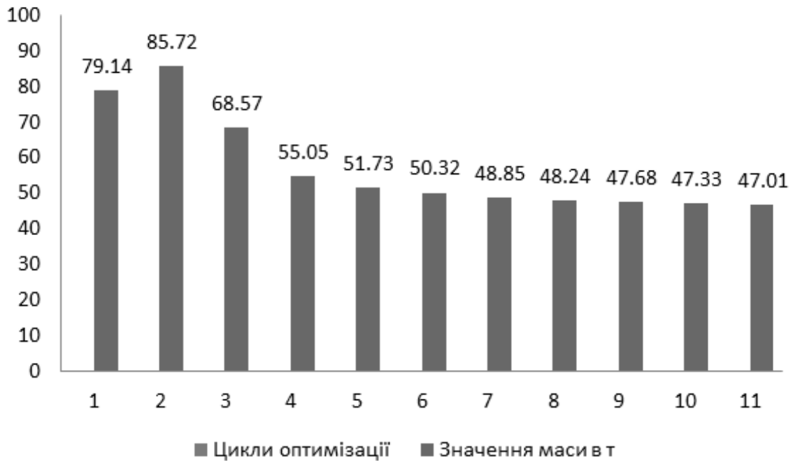
Рис 3.2. Діаграма зменшення маси оболонки по циклам оптимізації
