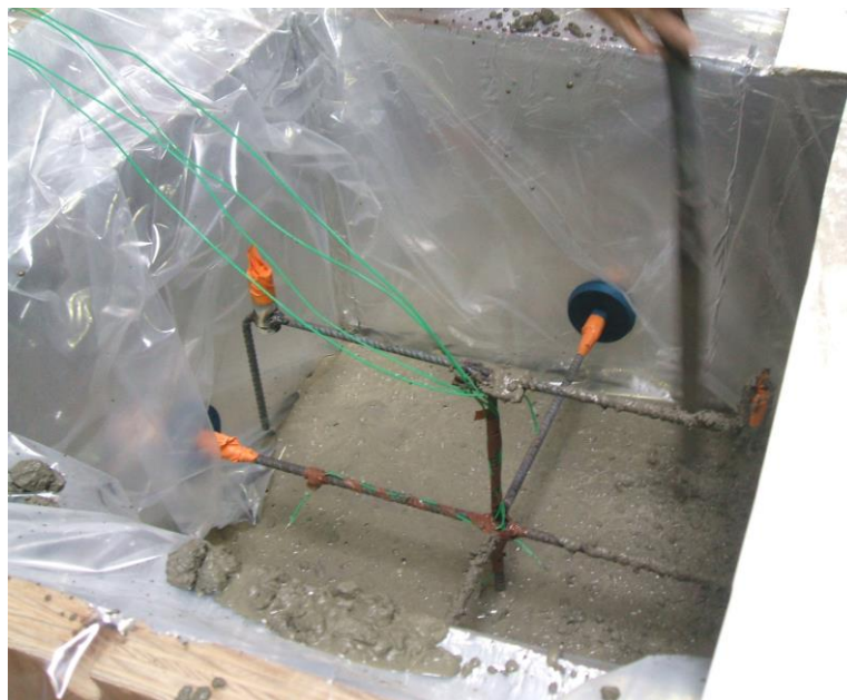
Рис. 4.25. Модельний куб бетону з вмонтованими термодатчиками
