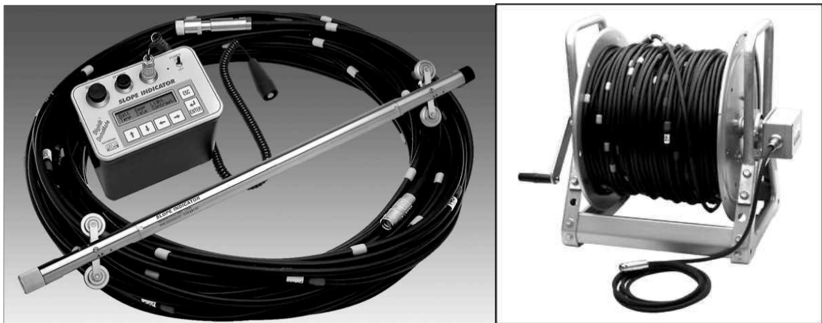
Рис. 1 – Обладнання інклінометричної системи
