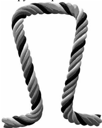
Рис. 14. Тривимірна модель петлі з крученої пряжі на основі нитки, що виготовлена з однієї сировини
