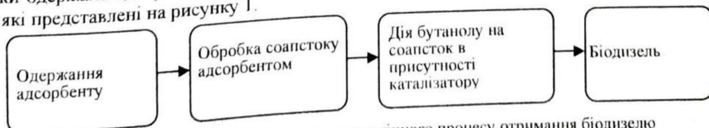
Рисунок 1 – Загальна схема технологічного процесу отримання біодизелю
