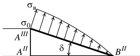
**Рис.6.** Эпюра давления на передней грани ножа
