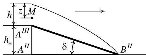
**Рис.7.** Параметры зоны деформации грунта перед ножом
