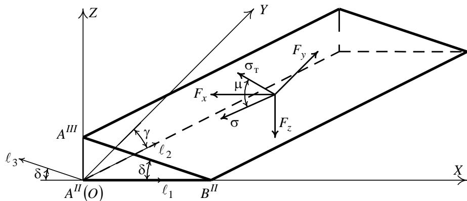
**Рис.8.** Схема сил, действующих на нож
