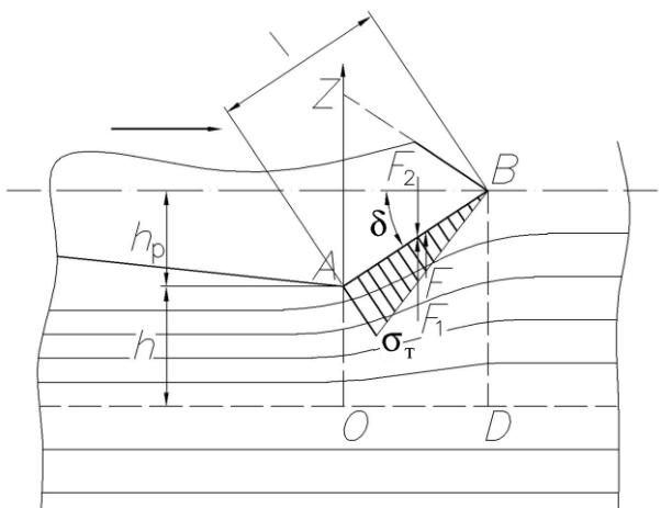
**Рис.1.** Расчетная схема щелевого резания грунта острым ножом:  $AB$  – профиль ножа;  $l$  – длина ножа;  $\delta$  – угол резания;  $h_p$  – толщина среза;  $h$  – толщина уплотненной части грунта;  $\sigma_t$  – максимальное давление на ноже (в точке  $A$ )
