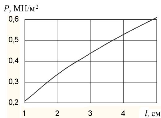
Рис.2. Эпюра давления на площадке износа ножа (данные Г.И. Алипова)
