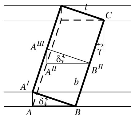
Рис.4. Нож, установленный под углом к траектории движения
