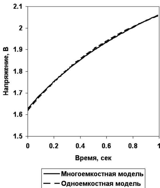
Рис. 8 - Динамика возрастания электрического напряжения на нагревателе
