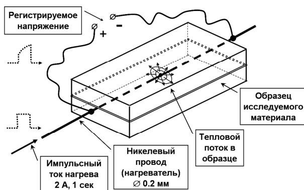
Рисунок 1 – Схема экспериментальной установки для определения удельного теплосопротивления
