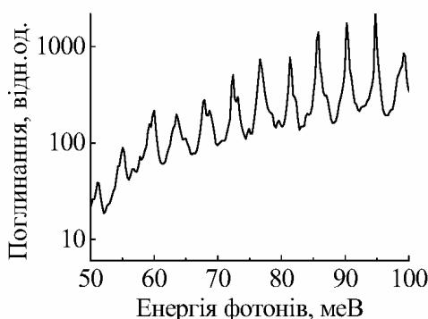
Рис.1. Резонансні осциляції оптичного ІЧ поглинання в спектральній області поверхневих станів  $Si-H_2$  для двовимірної структури макропористого кремнію з нанопокриттям нанокристалів  $ZnO$ .
