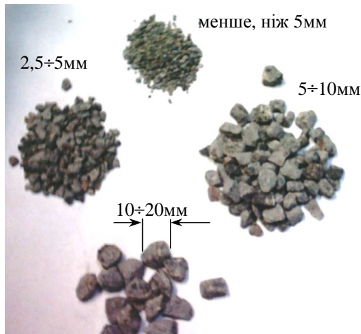
Рис. 3. Заповнювач після переробки має обкатану (кубоподібну) форму
