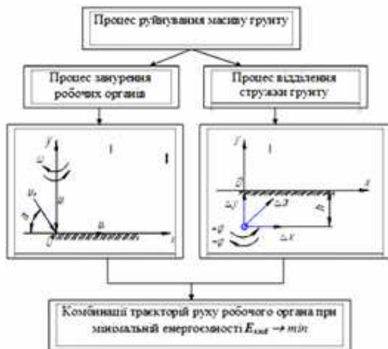
Рис. 1. Структурна схема формування й дослідження комбінованих робочих органів
