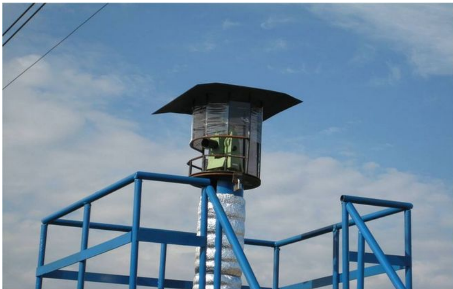
Рис.4. Автоматизований електронний тахеометр в роботі
