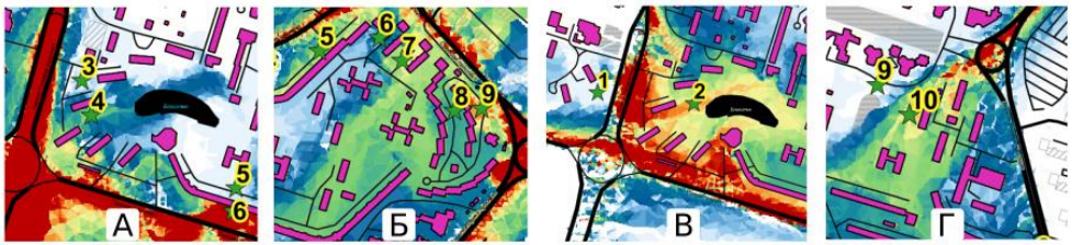
Рис. 8 – Вплив плану розташування будинків на перерозподіл ЗР: А – південно-західне засмоктання ЗР за північно-східного вітру; Б – північно-східне засмоктання ЗР за західного напрямку вітру; В – пряме західне перенесення ЗР; пряме північно-східне перенесення ЗР; (нумеральні позначки – пункти контрольних замірів)
