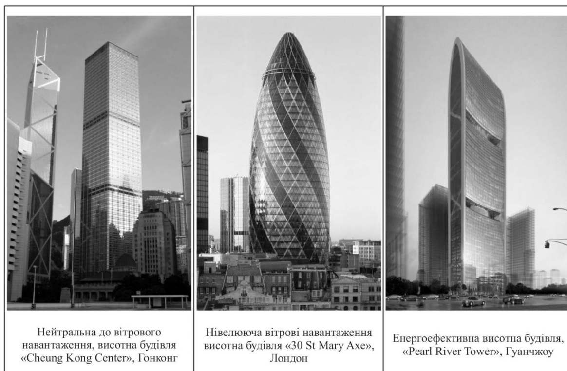
Рис. 1. Типи висотних будівель, які сформовані у залежності від способу сприйняття ними вітрового навантаження
