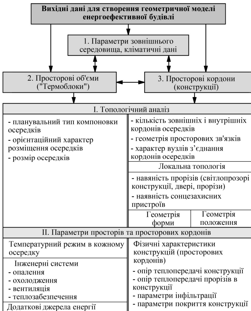
Рис.1. Вихідні дані для створення геометричної моделі енергоефективної будівлі
