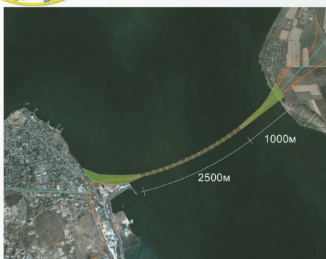
Двухъярусный мост предполагается разместить на 15-18-ти опорах при пролете от 120-150м.
