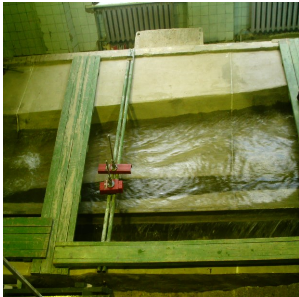
Фото 5. Гідравлічні дослідження бокового водозабору протипаводкової ємкості на р. Бистриця біля с. Тершаків у Львівській обл.
