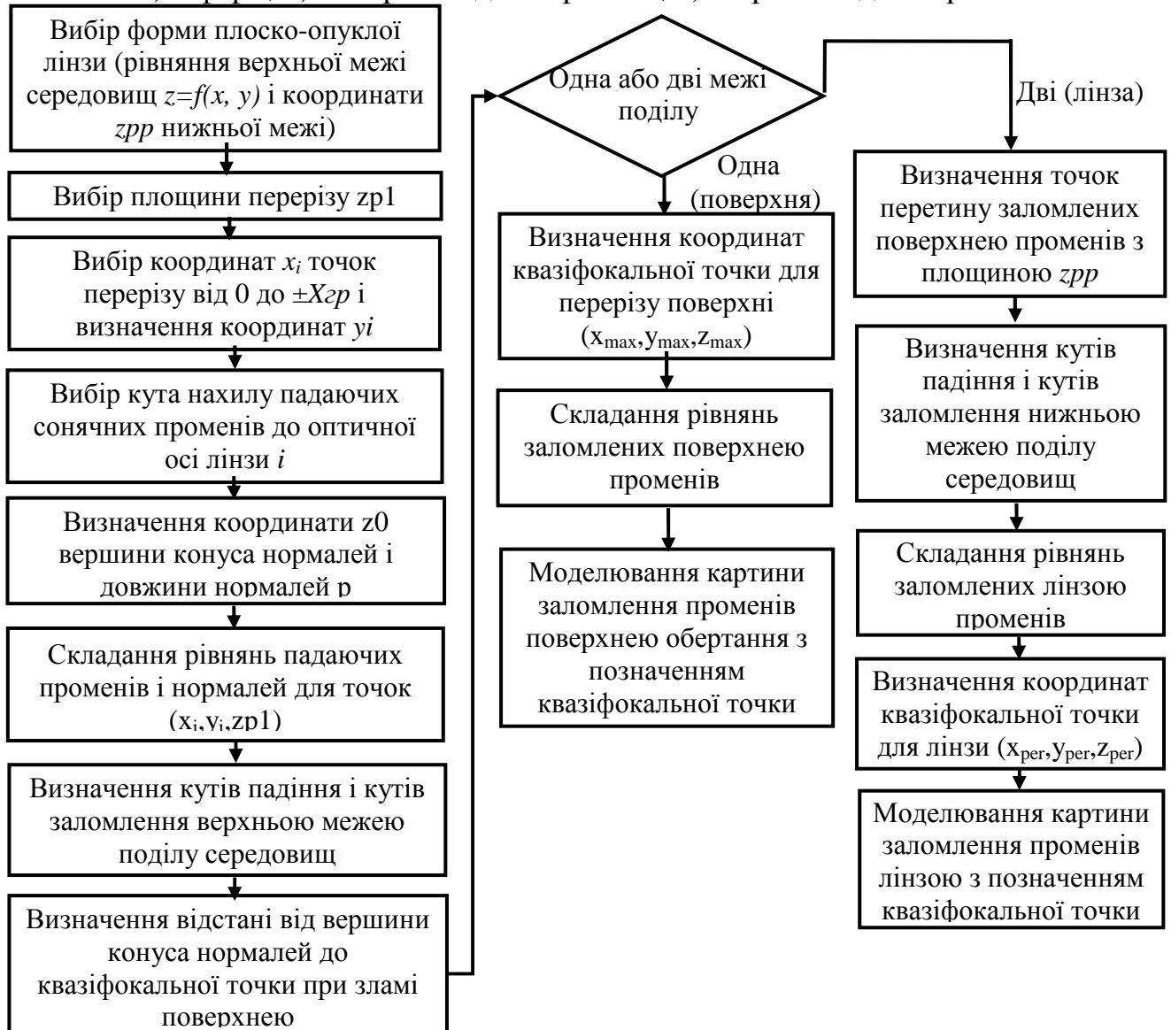
Рис. 6. Алгоритм визначення квазіфокальних точок
