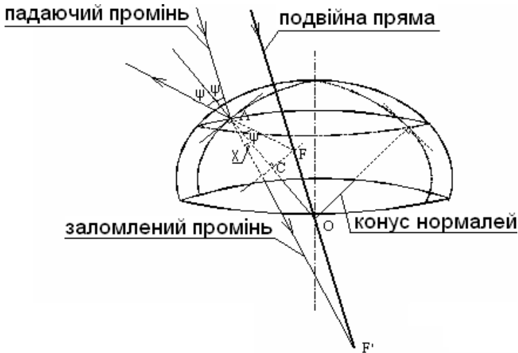
Рис. 4. Квазіфокальні точки при зламї та відображенні сонячного променя поверхнею обертання
