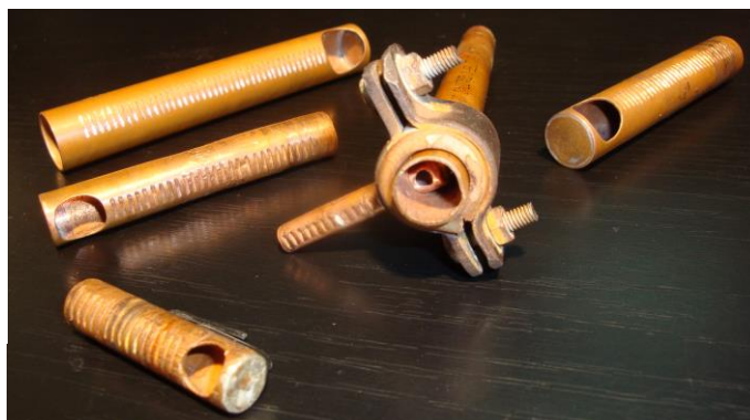
Рис. 7. Вхідні циліндричні насадки з ортогональним бічним виходом: а – схема; б – загальний вигляд
