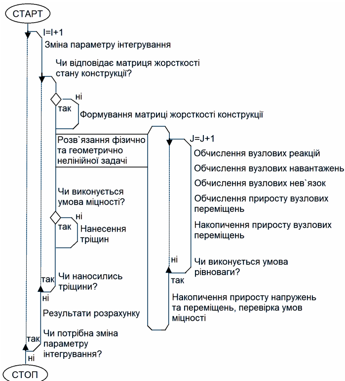
Рис. 1. Алгоритм чисельного моделювання деформування та руйнування залізобетонних конструкцій
